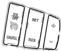
Les boutons sur le côté droit du rembourrage du klaxon commandent les fonctions du régulateur de vitesse. (Si le véhicule est doté de régulateur automatique de vitesse prédictif, ces boutons commanderont ce système.)
