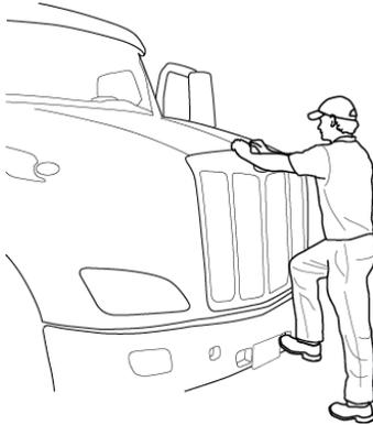
Le levier de déclenchement du dispositif de maintien du capot se trouve près de la charnière avant du capot.
