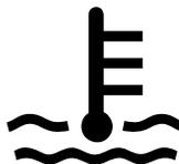
Dans des conditions normales de fonctionnement, l'indicateur de température doit indiquer 165°F à 205°F (74°C à 90°C). Dans certaines conditions, des températures un peu plus élevées peuvent être acceptables. Mais la température maximale admissible est de 210°F (99°C), sauf dans le cas de certains moteurs spéciaux. Vérifiez-la dans le manuel d'utilisation du moteur.
