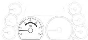
La position et la taille de cette barre est fonction de l'installation du moteur en usine. Le conducteur devrait avoir pour objectif d'opter pour une vitesse qui permet de maintenir, tant que possible, l'aiguille du compte-tours au-dessus de la lumière
