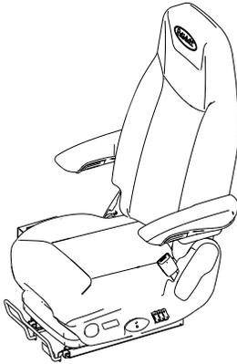
Les sièges de ce véhicule sont munis d'une commande qui verrouille la fonction d'isolation avant et arrière du siège. Verrouillé, aucun mouvement avant et arrière du siège n'est permis. Il sera fixé de manière rigide et ne se déplacera que vers le haut et le bas selon les mouvements du véhicule.
