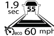
Le régulateur de vitesse adaptatif régulier ainsi que l'adaptatif avec suivi de voies montrera la distance jusqu'à l'objet qui précède (mesuré en secondes) à gauche de l'icône du véhicule. La vitesse de consigne du régulateur de vitesse s'affiche au bas de l'affichage. Les véhicules avec suivi de voie comporte aussi un numéro à l'intérieur de l'icône de la voiture.
