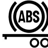
1. S'allume pendant l'autotest de mise en circuit en mettant le commutateur d'allumage en marche. S'éteint après quelques secondes si aucun problème n'a été détecté dans le système. L'autotest de l'ampoule se fait lorsque le commutateur d'allumage est mis en marche, que le véhicule soit équipé du système ABS de remorque ou non. Si un système ABS de remorque est détecté, le témoin s'éteint après quelques
