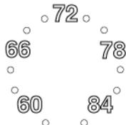
On règle la température de la cabine à l'aide du sélecteur de température. La plage de fonctionnement se situe entre 60 °F (16 °C) et 84 °F (28 °C). Les ajustements sont effectués par incréments de deux degrés.
