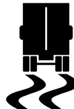
Calcule la direction prévue par le conducteur en fonction des données des capteurs de vitesse de roue et de l'angle de braquage, puis compare ces calculs à la direction effective du déplacement. Le système utilise les freins de roue individuels pour réajuster la direction du véhicule.
