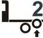
Mettez en fonction le commutateur de commande d'abaissement de l'essieu traîné.
