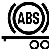
1. S'allume pendant l'autotest de mise en circuit en mettant le commutateur d'allumage en marche. S'éteint après quelques secondes si aucun problème n'a été détecté dans le système. L'autotest de l'ampoule se fait lorsque le commutateur d'allumage est mis en marche, que le véhicule soit équipé du système ABS de remorque ou non. Si un système ABS de remorque est détecté, le témoin s'éteint après quelques secondes si aucun problème n'est décelé dans le système.
