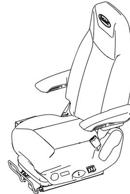
Les sièges de ce véhicule sont munis d'une commande qui verrouille la fonction d'isolation avant et arrière du siège. Verrouillé, aucun mouvement avant et arrière du siège n'est permis. Il sera fixé de manière rigide et ne se déplacera que vers le haut et le bas selon les mouvements du véhicule.
