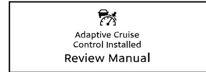
Cette indication au démarrage du véhicule signifie qu'il est équipé d'un régulateur de vitesse adaptatif (ACC) et d'un dispositif d'atténuation des collisions. Ces caractéristiques se combinent pour améliorer la sécurité des conducteurs et leur expérience de conduite. Lorsque le régulateur de vitesse est activé, l'ACC accélère et ralentit le camion pour
