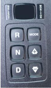
Le camion doit être au point mort pour l'allumer.
