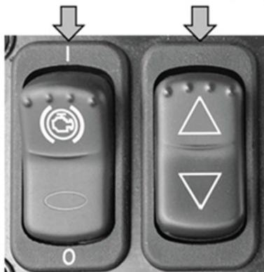
En appuyant sur le commutateur gauche, le conducteur peut activer ou désactiver le freinage régénératif. En appuyant sur le commutateur droit, le
