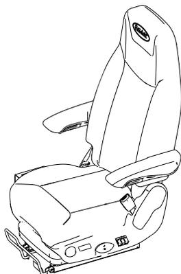
Les sièges de ce véhicule sont munis d'une commande qui verrouille la fonction d'isolement avant et arrière du siège. Verrouillé, aucun mouvement avant et arrière du siège n'est permis. Il sera fixé de manière rigide et ne se déplacera que vers le haut et le bas selon les mouvements du véhicule.
