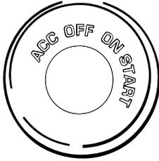
**OFF (Arrêt) :** Dans cette position, les accessoires sont hors circuit (sauf ceux qui sont indiqués ci-dessous) et il est possible de retirer la clé.
