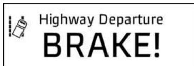
Le HDB fonctionne en même temps que l'alerte de sortie de route (LDW). Le LDW peut avertir d'une sortie de route avant que le freinage ne soit effectué lors d'un événement HDB (voir Avertissement de sortie de voie).
