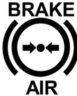
S'allume lorsque la pression d'air du système chute en dessous de 60 psi.
