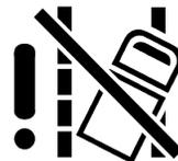
Ce voyant ambre s'allume lorsqu'une défaillance se produit dans le système d'alerte de sortie de voie (LDW). Si cela se produit, la fonction LDW sera désactivée.
