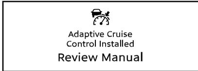
Cette indication au démarrage du véhicule signifie qu'il est équipé d'un régulateur de vitesse adaptatif (ACC) et d'un dispositif d'atténuation des collisions. Ces caractéristiques se combinent pour améliorer la sécurité des conducteurs et leur expérience de conduite. Lorsque le régulateur de vitesse est activé, l'ACC accélère et ralentit le camion pour maintenir une distance choisie par rapport à un véhicule avant détecté. Le
