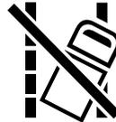
Le commutateur de désactivation du système d'alerte de sortie de voie (LDW) désactive les alertes sonores et visuelles du système pendant 15 minutes (ou jusqu'au prochain cycle de clé de contact), après quoi le LDW se réactivera automatiquement. Ce commutateur n'affectera pas les alertes sonores ou visuelles pour la fonction de régulateur de vitesse adaptatif (ACC). Ce commutateur s'allume en vert lorsqu'il est actif.
