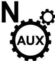
S'allume pour indiquer que la boîte de vitesses auxiliaire est en position point mort.
