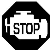
Ce témoin s'allume et une alarme retentit en présence d'une grave défaillance du moteur.
