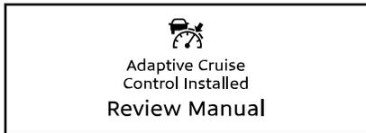
Cette indication au démarrage du véhicule signifie qu'il est équipé d'un régulateur de vitesse adaptatif (ACC) et d'un dispositif d'atténuation des collisions. Ces caractéristiques se combinent pour améliorer la sécurité des conducteurs et leur expérience de conduite. Lorsque le régulateur de vitesse est activé, l'ACC accélère et ralentit le camion pour maintenir une distance choisie par rapport
