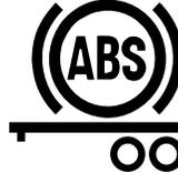
Il s'allume au cours du test d'ampoule et lorsque le tracteur-camion est accouplé à une remorque équipée d'un système de freinage antiblocage (ABS). Il s'allume dans des conditions normales de fonctionnement pour indiquer une défaillance du système de freinage antiblocage (ABS) de la remorque. Faites-le vérifier sans tarder par un concessionnaire agréé.
