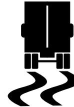
Calcule la direction prévue par le conducteur en fonction des données des capteurs de vitesse de roue et de l'angle de braquage, puis compare ces calculs à la direction effective du déplacement. Le système utilise les freins de roue individuels pour réajuster la direction du véhicule.
